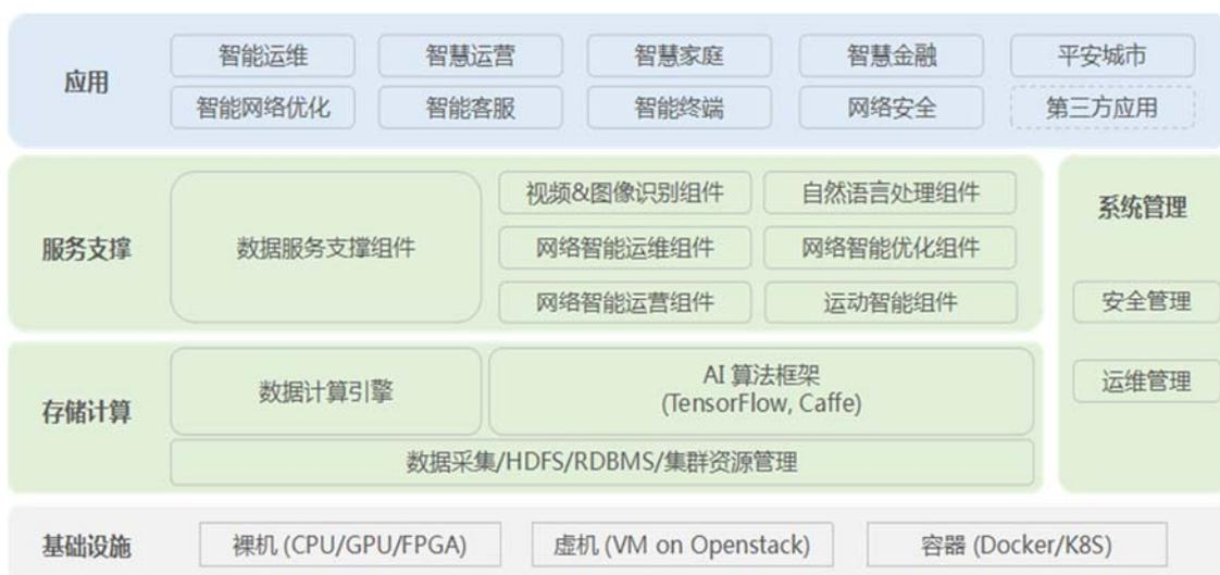
图 8 网络人工智能平台参考架构
