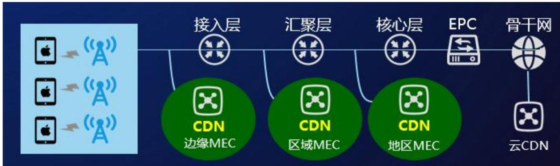
图 6 基于 MEC 的移动边缘 CDN
