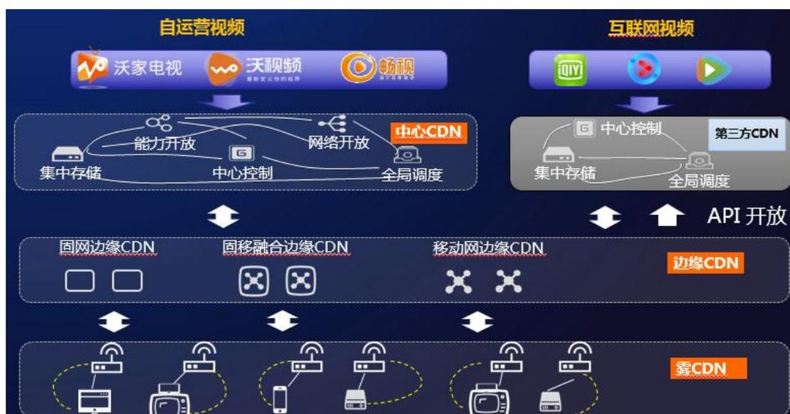
图 1 中国联通 CUBE-CDN 目标技术架构
