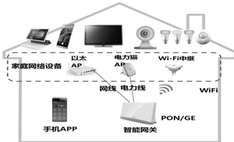
图 2-1 家庭 Wi-Fi 网络架构示意图
